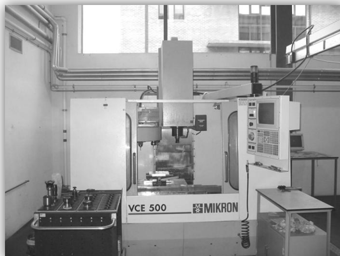
Figura 56 – Máquina fresadora CNC de 3 eixos MIKRON VCE 500 Volume de trabalho: 500 \times 400 \times 400\text{mm}
